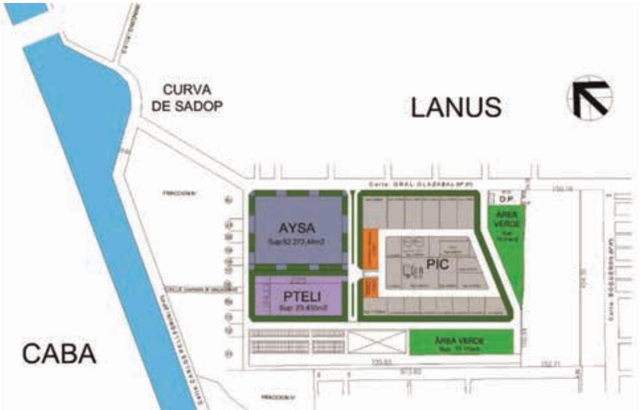
Figura 24: Esquema de implantación del Parque Industrial Curtidor PIC y de la Planta de Tratamiento de Efluentes Líquidos PTELI
