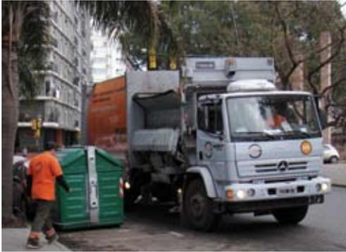
se utilizan contenedores metálicos de carga lateral de 2.4 y 3.2 m<sup>3</sup> de capacidad. En lo que respecta a los barrios con cordón cunetas, se emplean contenedores plásticos y metálicos de carga trasera de 1.2 m<sup>3</sup>.
